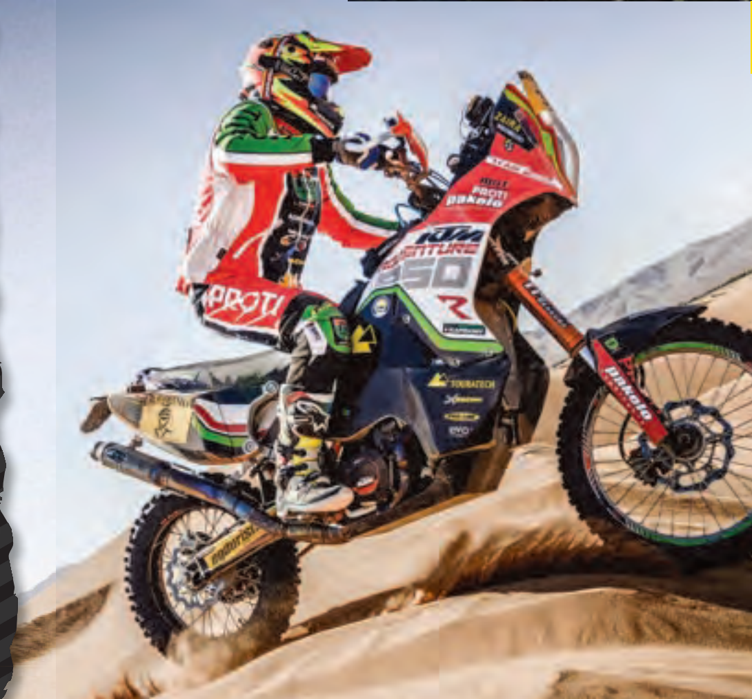
Nell'anteriore, il cupolino è realizzato da MST di Reggio Emilia, mentre la forcella è una Kayaba ad aria.
