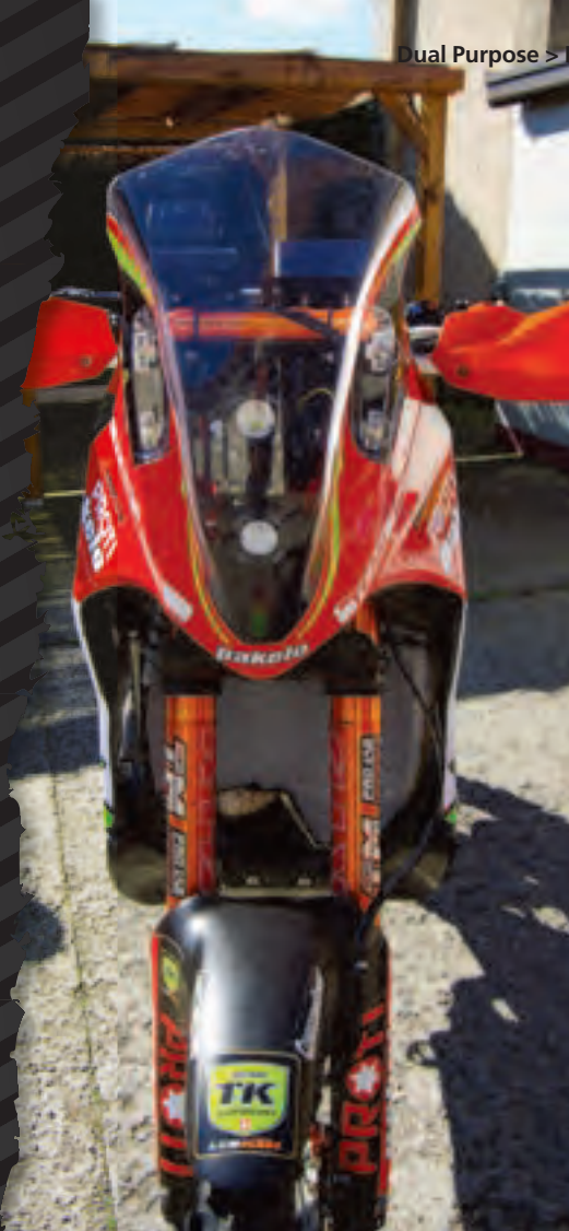
Nell'anteriore, il cupolino è realizzato da MST di Reggio Emilia, mentre la forcella è una Kayaba ad aria.
